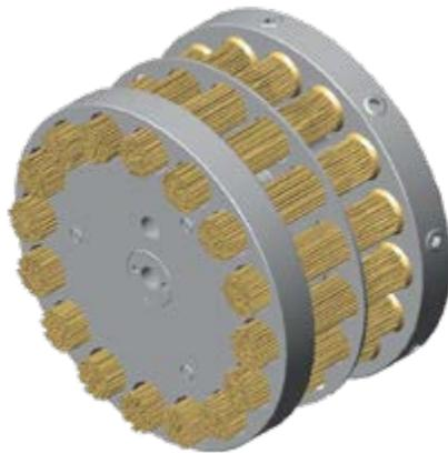
Schematische Darstellung eines Bürskopfes für Entgratpinsel
